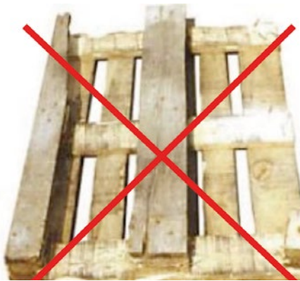
Bottom edge board missing
